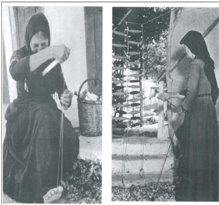
Εικόνα 9. Αριστερά, με μοχλό το μεγάλο δάκτυλο του ποδιού, περνά το νήμα από την ματσέτα στα μασούρια. Δίπλα, μόλις αρχίζει το διασίδι, με το οποίο θα φτιάξει τις βροχίδες, για να πάνε, μετά, για τύλιγμα στο αντί, να στηθεί στον αργαλειό και να αρχίσει να υφαίνει τα ρούχα του σπιτιού και τα προικιά των κοριτσιών.
