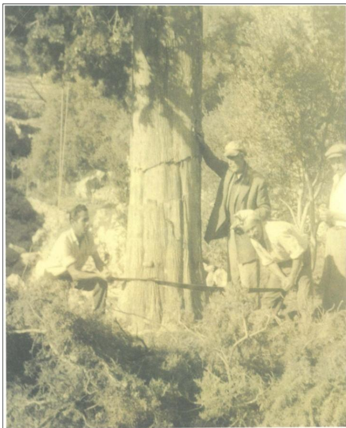
Εικόνα 21. Κοπή κυπαρισσιού με τον καταρράχτη. Στην προκειμένη περίπτωση το πριόνι δε φέρει το μεγάλο παραλληλόγραμο ξύλινο πλαίσιο, που χρησιμοποιούσαν κατά την επεξεργασία των κυπαρισσιών, αφού τα στάφνιζαν με κόκκινο χρώμα. Η σκληρή δουλειά μόλις άρχισε, προκειμένου να δημιουργηθούν τα ματέρια, οι καρίνες, τα ψαλίδια, οι τάβλες και σκόρτσα.
